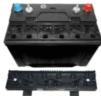
Locket är specialutformat för att klara av att återvinna de gasångor, som bildas i batteriet, till vatten. Det pågår alltså ett ständigt kretslopp i batteriet.
